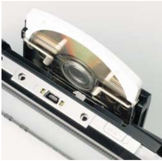
An der PSP-Rückseite werden die 1,8 GByte fassenden UMDs in den Laufwerkschacht geschoben.
